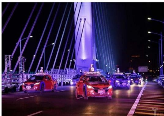
图 1.7 百度Apollo车辆队列控制实验
