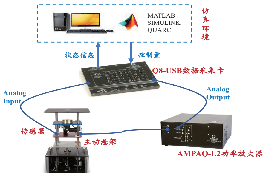
图 3.4 主动悬架硬件在环实验台实时工作原理
